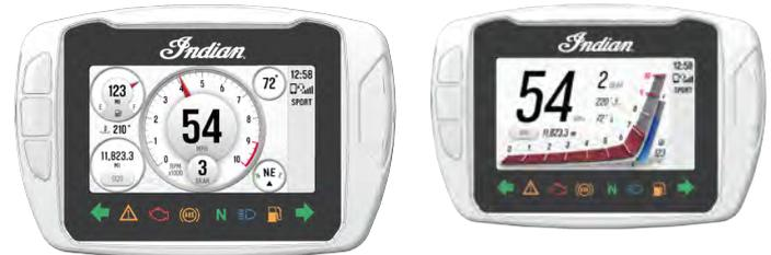
Der Instrumentenbildschirm zeigt die Geschwindigkeit des Fahrzeugs, den aktuellen Gang, den Kraftstoffstand und die Reichweite, die Umgebungs- und Motortemperatur, den Kilometerzähler, den Streckenkilometerzähler und den Kompass an. Es stehen zwei verschiedene Anzeigetypen zur Auswahl, rund oder linear (beide oben dargestellt). Die Displayausführung kann gewechselt werden, indem auf dem Touchscreen nach oben oder unten gewischt wird oder indem der Joystick nach oben oder unten gedrückt wird.
