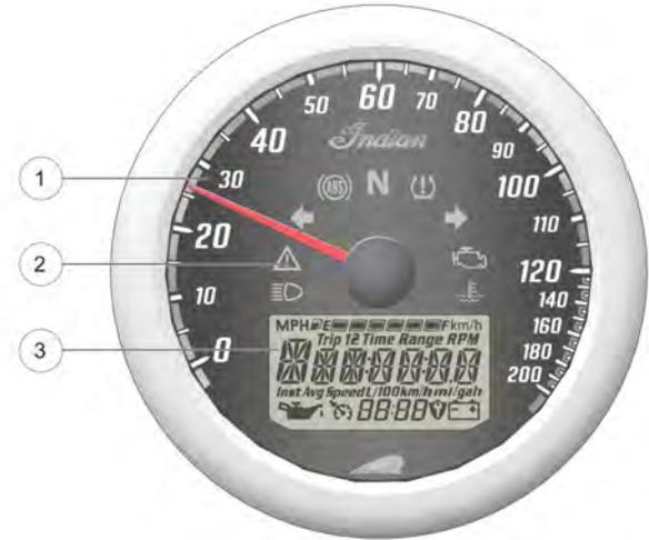
Das Kombiinstrument besteht aus Tachometer, Kontrollleuchten und Multifunktionsanzeige (MFD).
