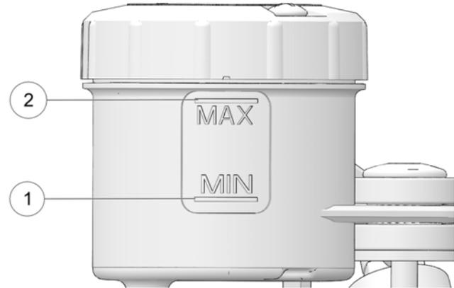
2. Den Vorderrad-Bremsflüssigkeitsstand durch den Flüssigkeitsbehälter beobachten. Die Bremsflüssigkeit muss klar sein und ihr Stand muss sich zwischen den Markierungen MIN ① und MAX ② befinden.
