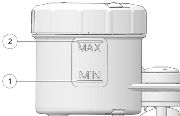
2. Den Vorderrad-Bremsflüssigkeitsstand durch den Flüssigkeitsbehälter beobachten. Die Bremsflüssigkeit muss klar sein und ihr Stand muss sich zwischen den Markierungen MIN ① und MAX ② befinden. Bei zu niedrigem Flüssigkeitsstand die Bremsbeläge gemäß Anweisung auf Seite 135 kontrollieren. Sind die Bremsbeläge noch nicht über die Verschleißgrenze hinaus abgenutzt, die Bremsanlage auf Undichtigkeiten prüfen.
