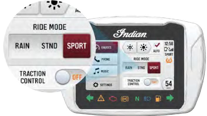
Es kann aus drei Fahrmodi gewählt werden: Regen, Standard und Sport. Dies dient der Anpassung des gewünschten Fahrstils. Die Motorkennlinien für die einzelnen Fahrmodi wurden für bestimmte Fahrweisen entwickelt, so dass ein Motorrad mit drei verschiedenen Persönlichkeiten entsteht.
